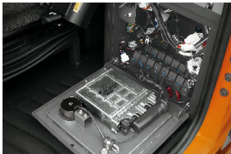
Diagnose transmissie De controlefunctie met laptop-PC laat aansluiting op het systeem toe. De status van de transmissie kan gemakkelijk worden gecontroleerd, en diverse instellingen zoals de slijtagecompensatie van de remschijven gebeuren automatisch, zonder onderdelen te demonteren.
