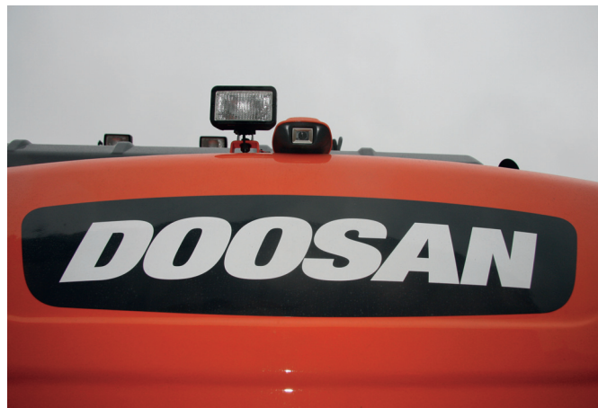
De achterzichtcamera houdt ook op de minder goed overzichtelijke punten van de machine veilig een oogje in het zeil.
